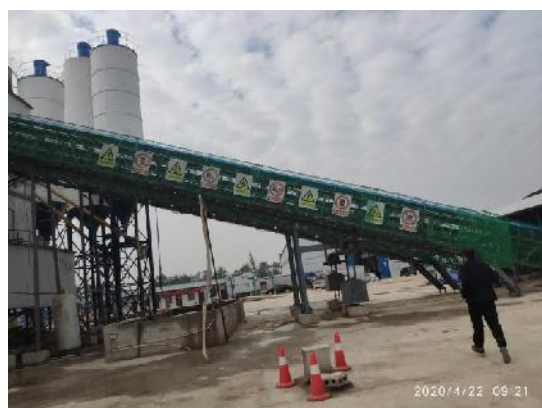
骨料输送带两侧设密目网
