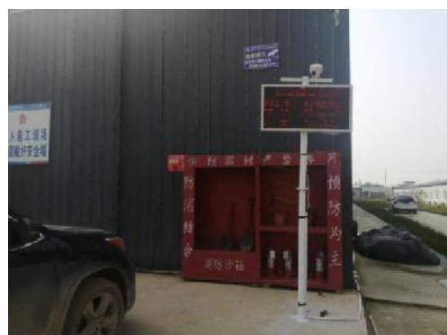
拌合站现场设置扬尘和噪声监测仪
