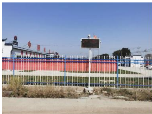
拌合站现场设置扬尘和噪声监测仪
